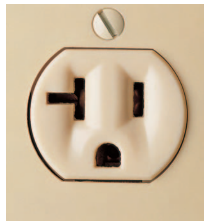
20 amperios y 120 voltios. Tiene tres entradas a tierra con una entrada especial en forma de "T". Se usa con grandes electrodomésticos o herramientas portátiles que requieren 20 amperios de corriente.
