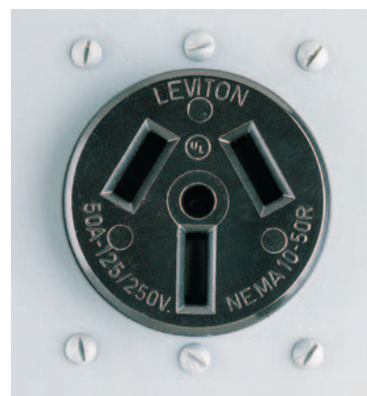
50 amperios y 125/250 voltios. Este tomacorriente es usado para estufas. La corriente de alto voltaje alimenta la bobina de calentamiento, y la corriente de 125 voltios opera relojes y luces.
