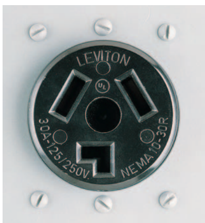
30 amperios y 125/250 voltios. Este tomacorriente es usado para secadoras de ropa. Provee corriente de alto voltaje para la bobina de calentamiento, y corriente de 125 voltios para operar luces y temporizadores.
